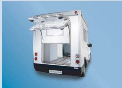
13_heckklappe_simulation1.jpg Außenansicht: Heckansicht von außen, Simulation der oberen Klappenfunktion
