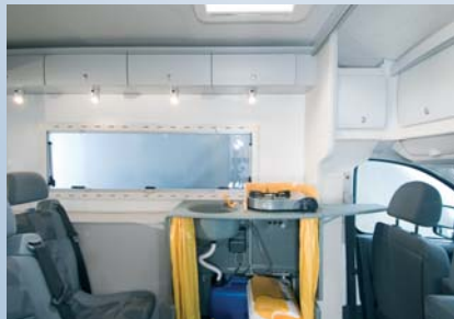
15_k-boxx_geoeffnet.jpg Innenansicht: Innenbereich mit geöffneter Seitz-K-Boxx (mobile Kocheinheit mit Zubehör)
